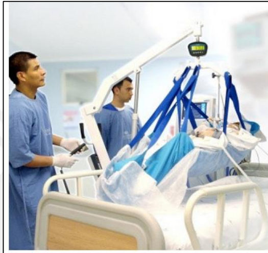
Figura 49: Grúa diseñadas para traslado de pacientes entre sillas, camas, camillas, etc y también permite pesarlo mediante una báscula. Elaboración Propia.
