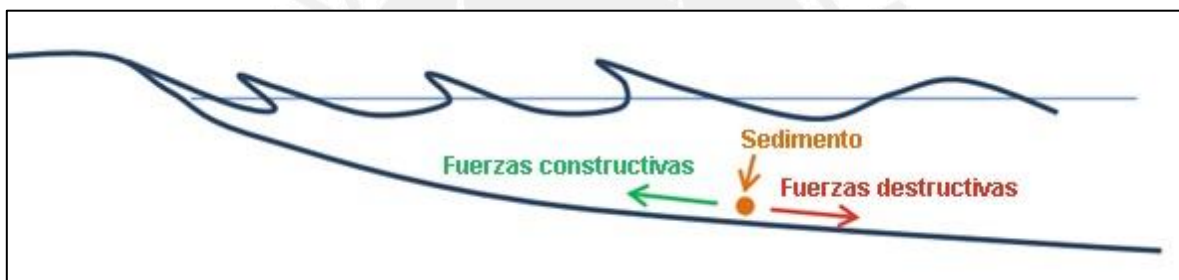
Figura 4. Fuerzas que actúan sobre el perfil de equilibrio.
