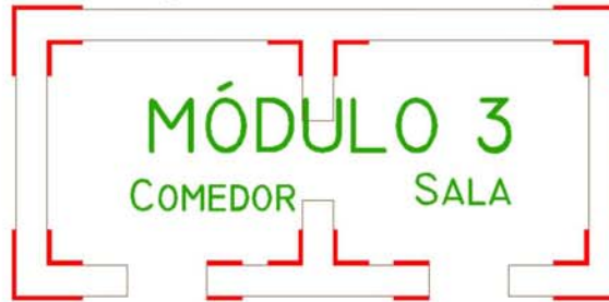
Figura 4.20. Refuerzo vertical obtenido en encuentro de muros del módulo 3.
