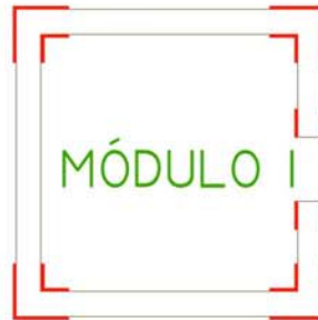
Figura 4.2. Mallas esquineras en el Módulo 1.
