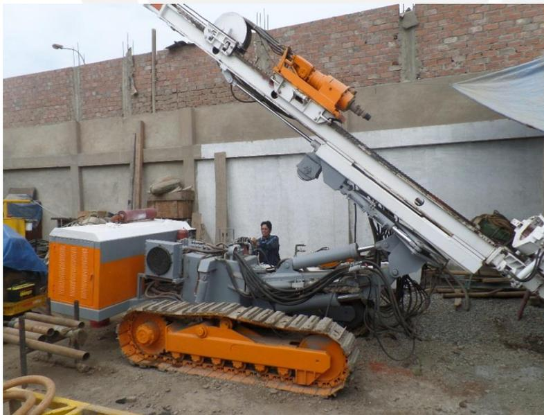
Figura 4. 2 Máquina Perforadora, inyectora Stenuik P600.<sup>38</sup>
