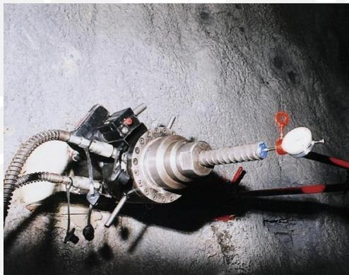
Figura 4. 9 Gata hidráulica efectuando prueba de carga en “nail”.<sup>43</sup>
