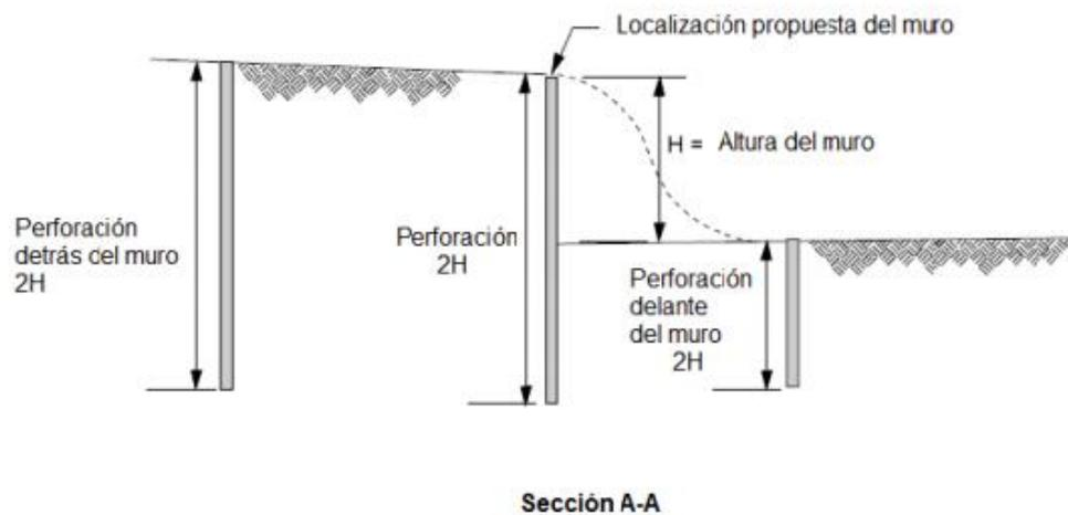
**Figura 3. 1 Ubicación de las perforaciones cercanas a la propuesta del muro para el estudio de suelos.**<sup>18</sup>
