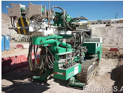
Figura 4. 8 Maquinaria para perforación de inclusión “nail”.<sup>42</sup>
