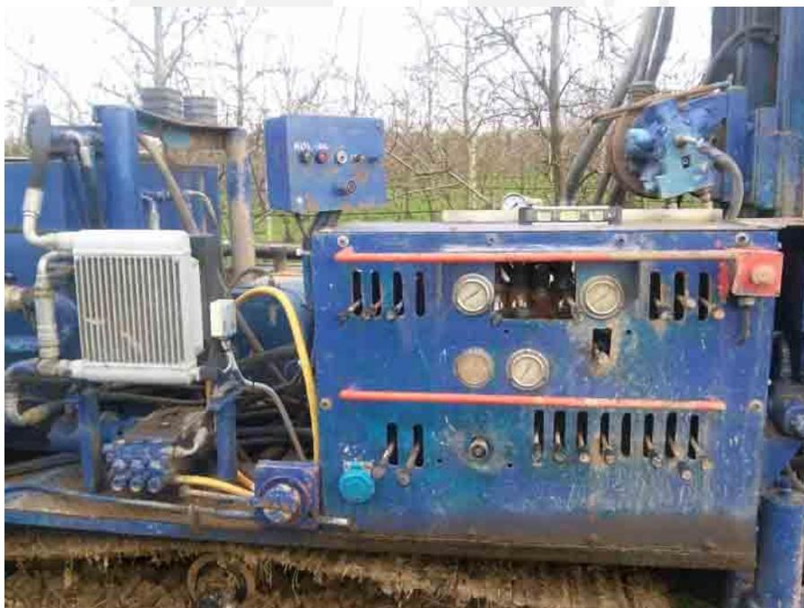
Figura 4. 3 Máquina Compresora de aire de 18 bares.<sup>39</sup>
