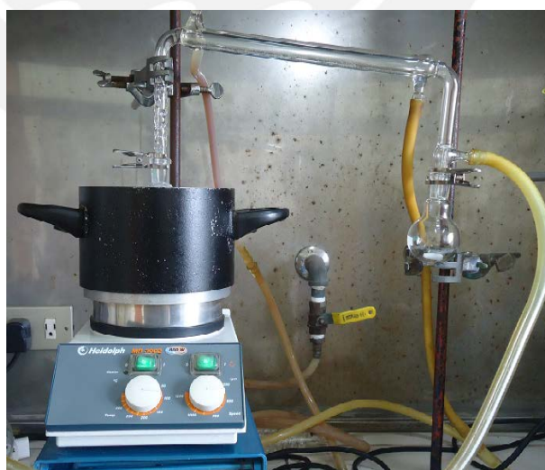
Figura 40: Destilación de ESTER-OXA. Laboratorio de Polímeros, Sección Física PUCP.
