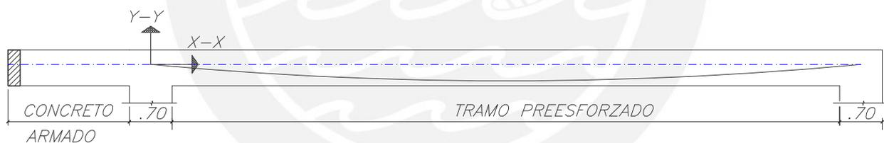
Fig. Cable resultante en viga postensada.
