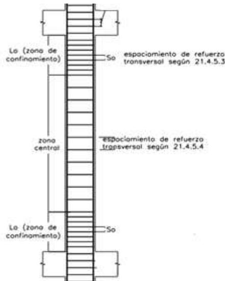
Fig. Bosquejo de requerimientos de estribos en columnas (RNE Norma E.060 2009)
