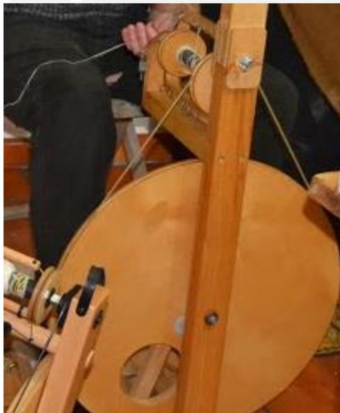
Figura A2-4: Mecanismo de transmisión en una rueca.
