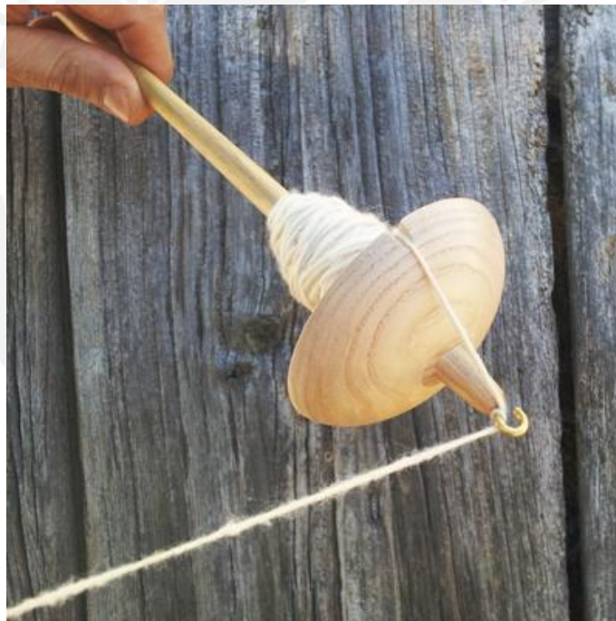
Figura 1.5: Muestra el almacenamiento del hilo en un huso. Fuente: [5]
