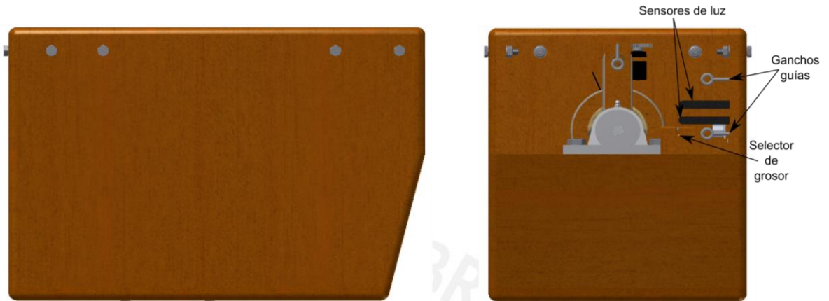
Figura 2.3.3: Vista lateral y frontal del sistema. Fuente: Elaboración propia.
