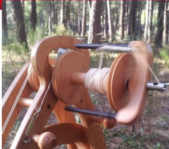
Figura 1.6: Muestra el almacenamiento del hilo en la bobina de una rueda. Fuente: [5]
