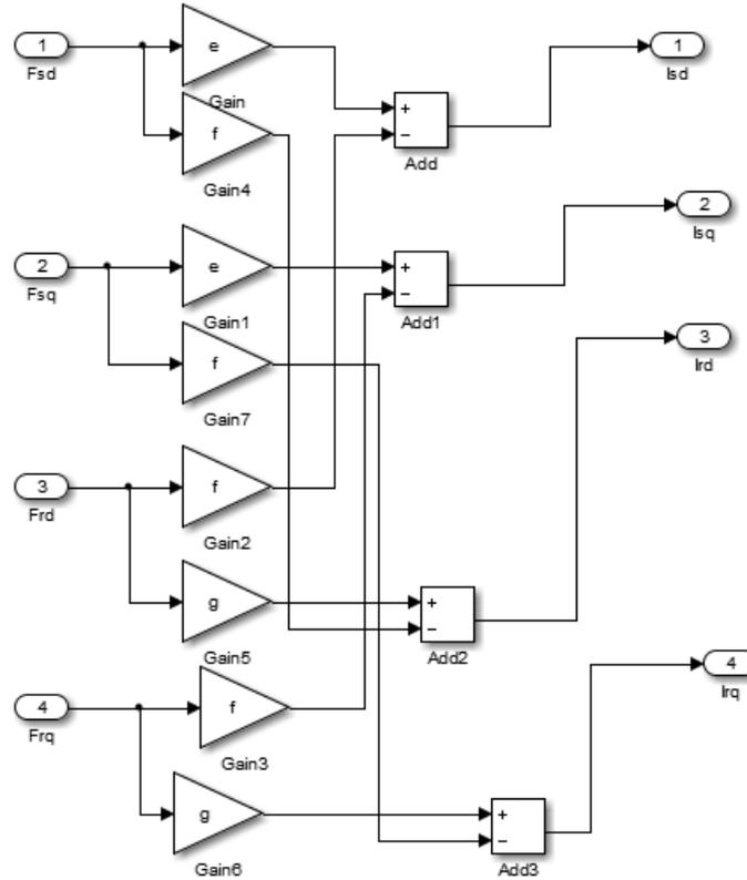
4.3 DIAGRAMA DEL BLOQUE 3 TORQUE ELÉCTRICO EN SIMULINK
