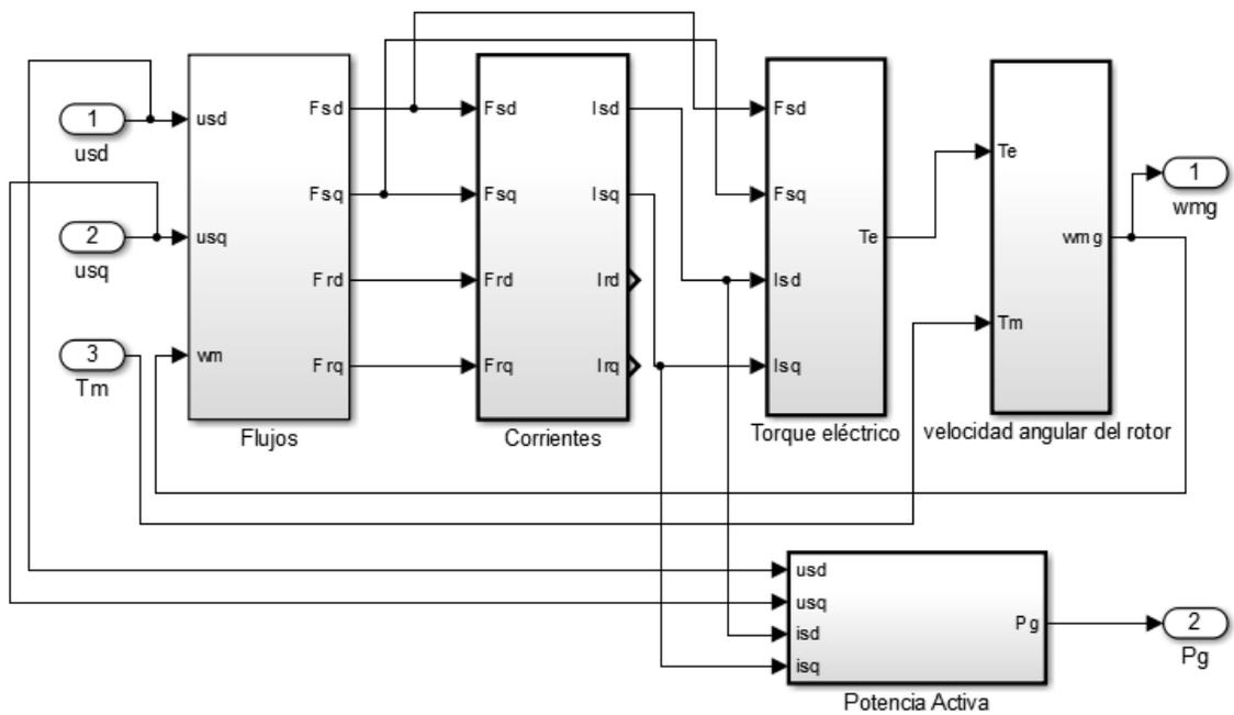
4.1 DIAGRAMA DEL BLOQUE 1 FLUJOS EN SIMULINK
