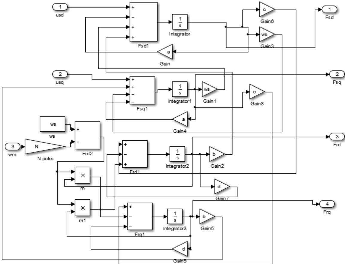
4.2 DIAGRAMA DEL BLOQUE 2 CORRIENTES EN SIMULINK
