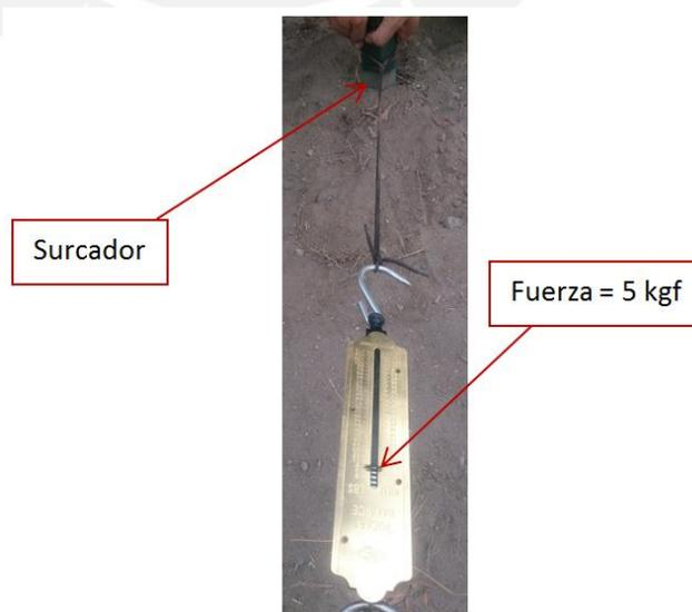
Figura 3.41. Componente horizontal de la resistencia del terreno (R)
