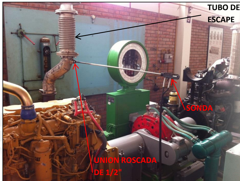
Figura 3.21 – Montaje de la sonda del testeo en el motor Caterpillar
