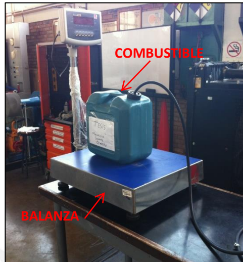
Figura 1.1 – Medición por el método gravimétrico
