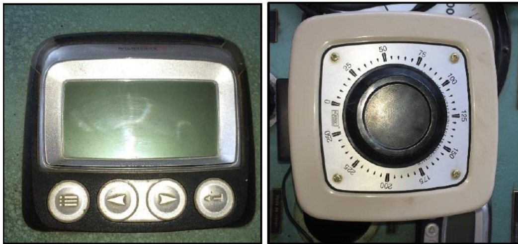
Figura 3.7 - Tacómetro digital (izquierda) y regulador de torque (derecha)
