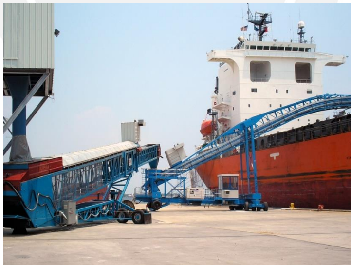
Figura 2.2. Imagen de un Cargador de barco móvil. Fuente: Aumund. [2]
