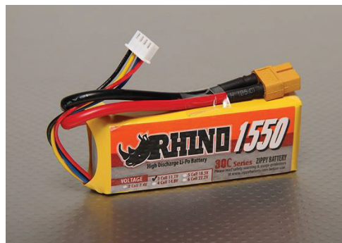
Figura 1 Batería LiPo Rhino de 1550mAh 3S 30C
