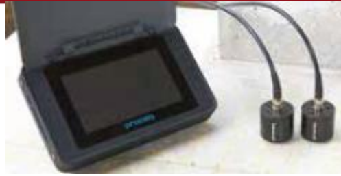
Figura 35: Equipo de ultrasonido (Ondas P). Fuente: PROCEQ S.A.
