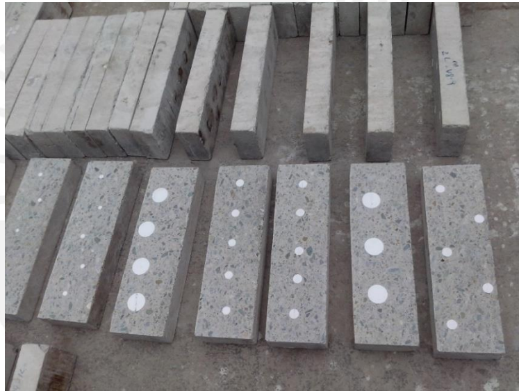
Figura 49: Corte de vigas de concreto.
