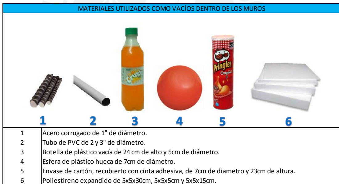
Figura 50: Materiales utilizados como vacíos dentro de los muros.
