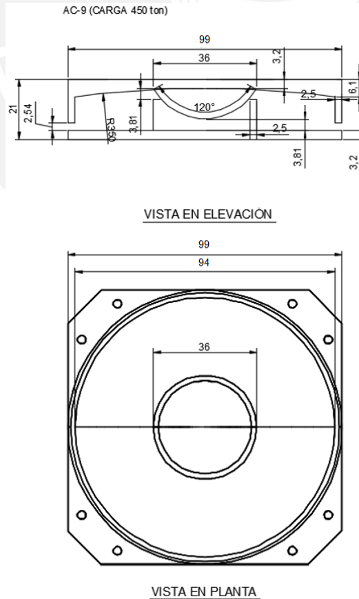
Fig. 6.27: Esquema del aislador AC-9 (Aislador central)
