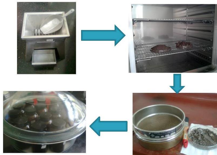
Figura 44. Preparación de muestras de suelo De esquina superior izquierda en sentido horario: cuarteo, secado en estufa, molienda y tamizado, y almacenaje de las muestras preparadas
