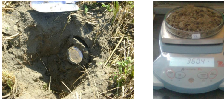
Figura 39. Determinación de densidad aparente in situ (izquierda) y pesaje del suelo seco del cilindro metálico en el laboratorio (derecha)
