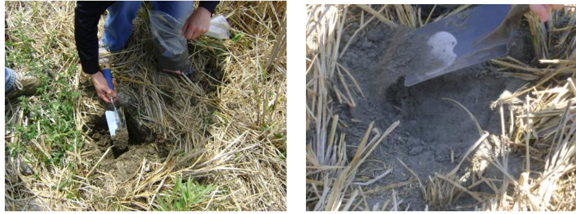
Figura 38. Toma de muestras en estaciones de muestreo Reconocimiento del área y remoción de la capa superficial del suelo (izquierda) y toma de muestras con rastrillo metálico (derecha)
