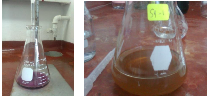
Figura 43. Formación del complejo inicial en la estandarización del EDTA (izquierda) y titulaciones de las muestras dosificadas (derecha)
