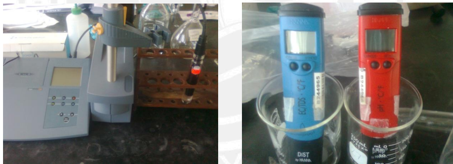
Figura 42. Medición de conductividad eléctrica (izquierda) y conductímetro y pH-metro portátiles empleados para el análisis (derecha)
