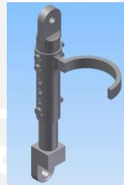
Figura 4.4: Diseño del subsistema Canilla-Pantorrilla<sup>35</sup>
