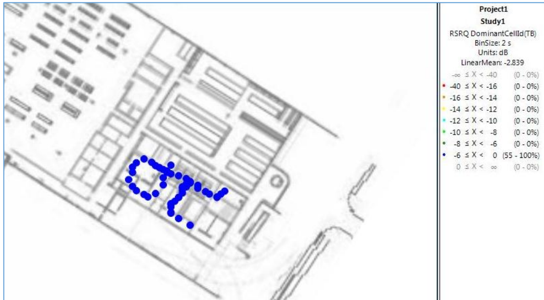
FIGURA 2-2: MEDICIÓN DE RSRQ EN PISO 1 – MEZZANINE
