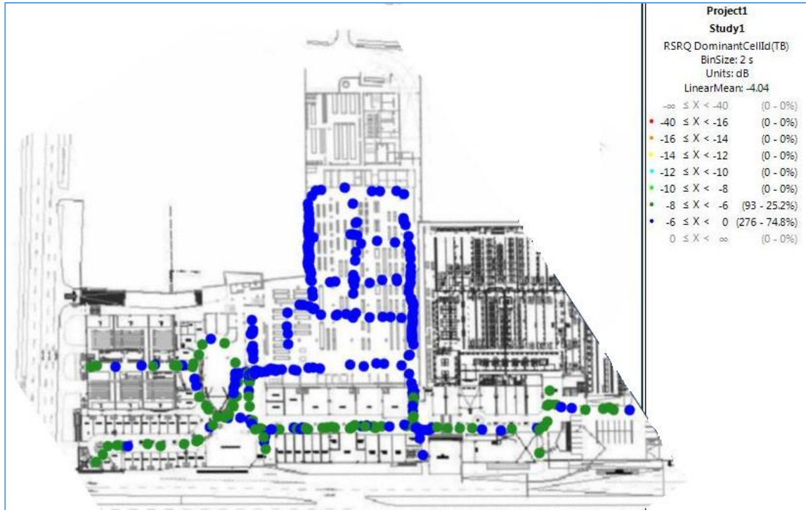
FIGURA 2-1: MEDICIÓN DE RSRQ EN PISO 1
