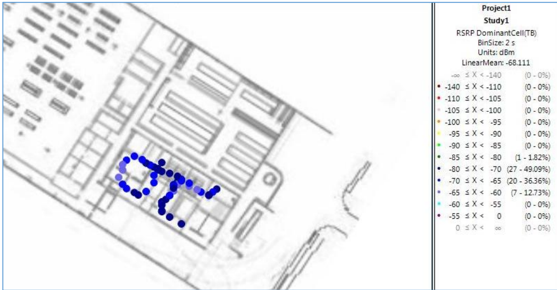
FIGURA 1-2: MEDICIÓN DE RSRP EN PISO 1 – MEZZANINE
