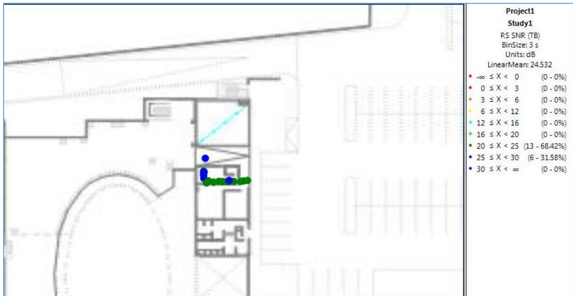
FIGURA 4-3: MEDICIÓN DE SNIR EN AZOTEA
