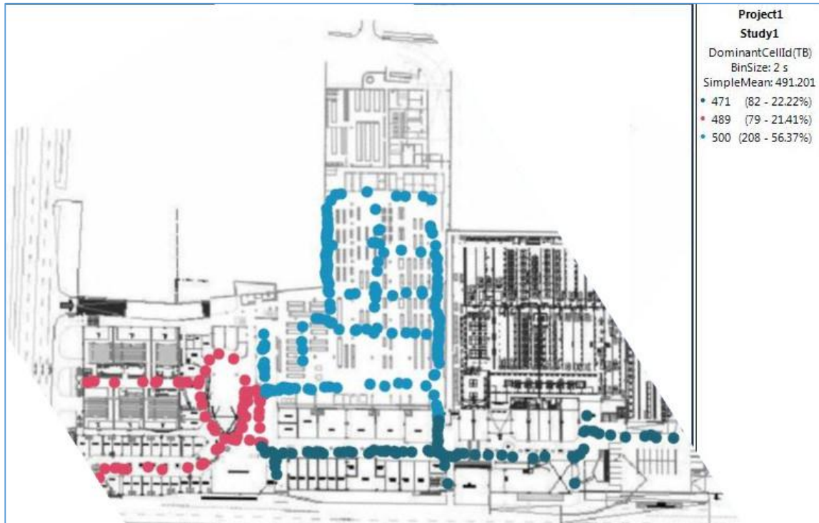
FIGURA 5-1: MEDICIÓN DE MEJOR SERVIDOR EN PISO 1
