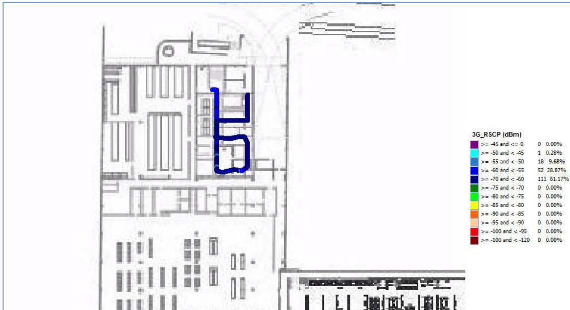
FIGURA 1-2: MEDICIÓN DE RSCP EN PISO 1 – MEZZANINE
