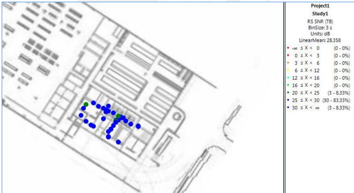
FIGURA 4-2: MEDICIÓN DE SNIR EN PISO 1 – MEZZANINE
