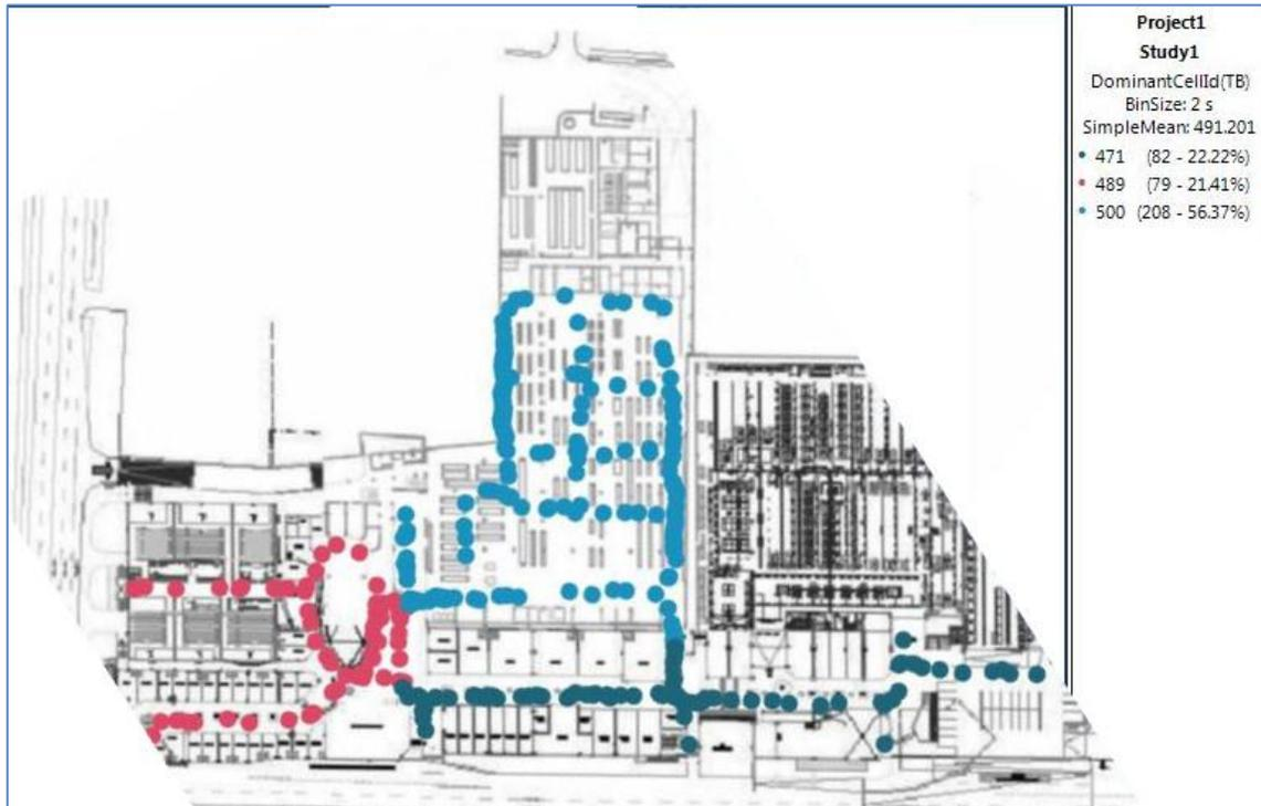
FIGURA 3-28: MEDICIÓN DE MEJOR SERVIDOR
