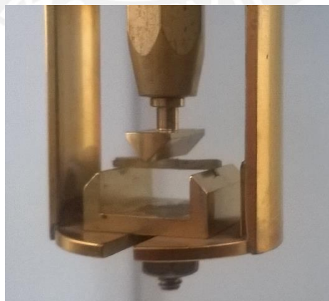
Figura 3. 3 Muestra antes de iniciar el ensayo dinámico-mecánico.
