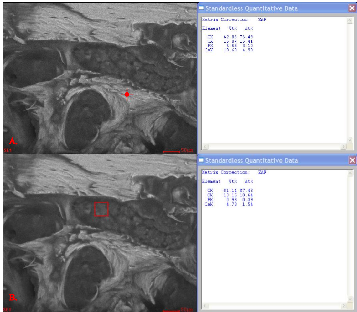
Figura 3. 13 En la figura "A" se observa la composición de un punto del material que forma los poros, el cual tiene una composición que coincide con la de la fase 2. En la figura "B" se muestra la composición de la materia encerrada en el cuadro rojo.
