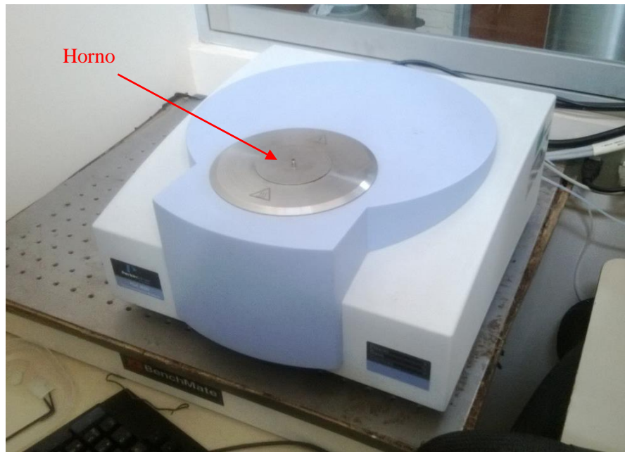
Figura 2. 4 Equipo TGA-Perkin Elmer usado, se identifica la ubicación del horno del equipo.
