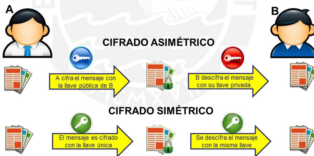
Imagen 11 – Criptografía Simétrica y Asimétrica (Adaptado de [47])
