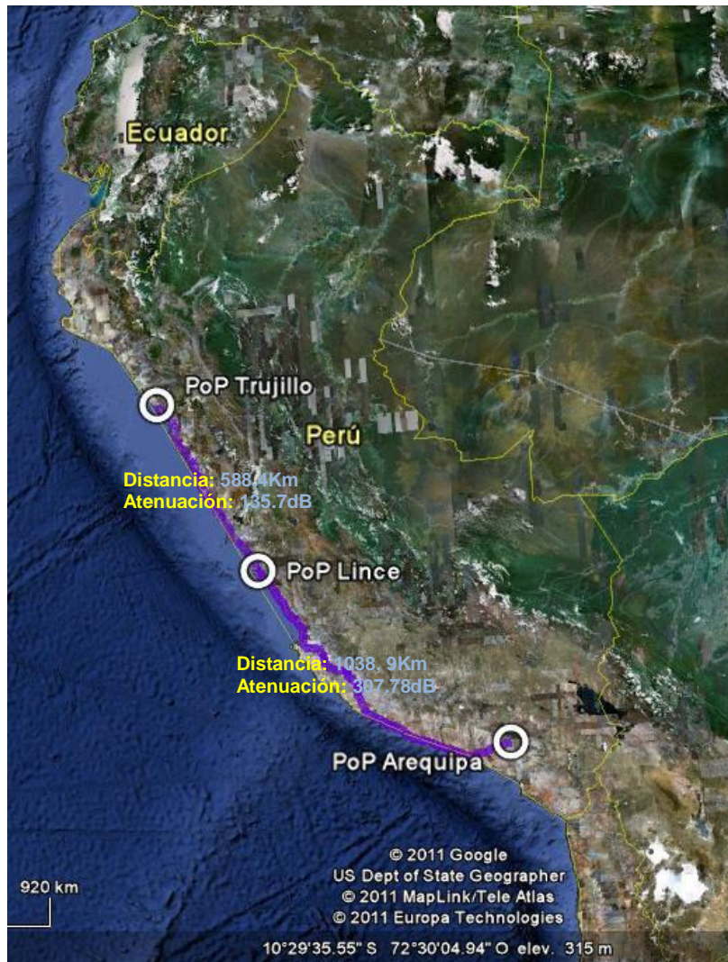
FIGURA 4-13: CANALIZACIÓN DEL BACKHAUL DE PERÚ (ENTRE TRUJILLO Y AREQUIPA)
