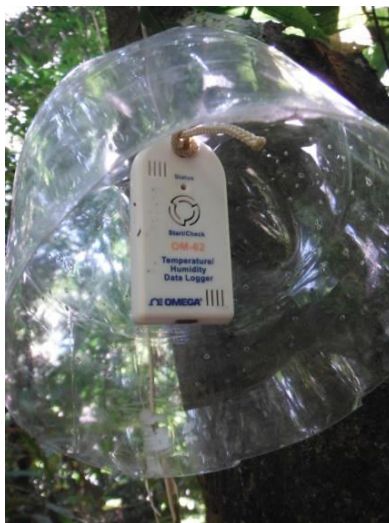
Figura 15. Sensor de temperatura y humedad utilizado en el trabajo de campo.
