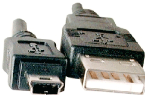
Comparativa mini usb macho tipo B y usb macho tipo A
