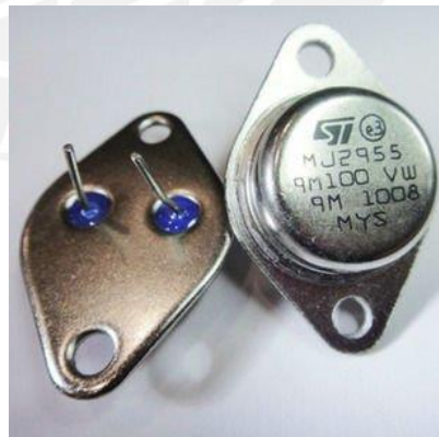
Figura 3.26. Transistor PNP MJ2955 empaque TO-3
