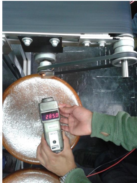
Figura 4.8 Medición de la velocidad usando un tacómetro digital
