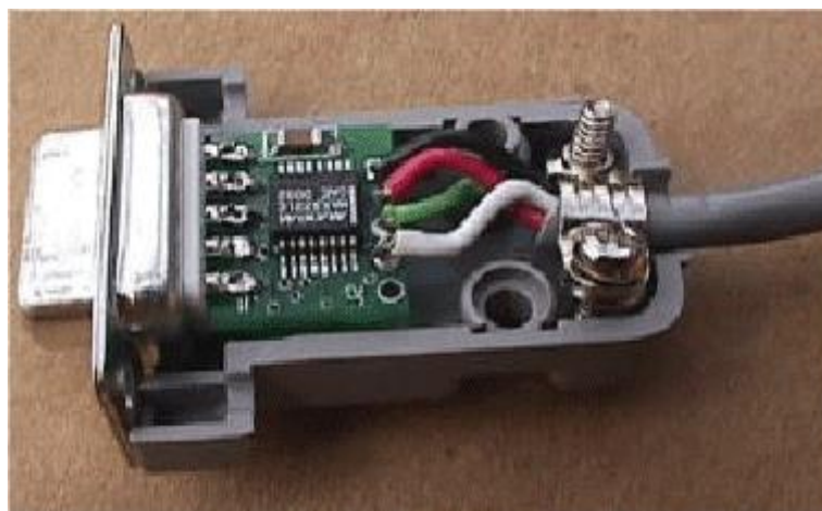
Cable adaptador TTL-RS232 basado en MAX232
