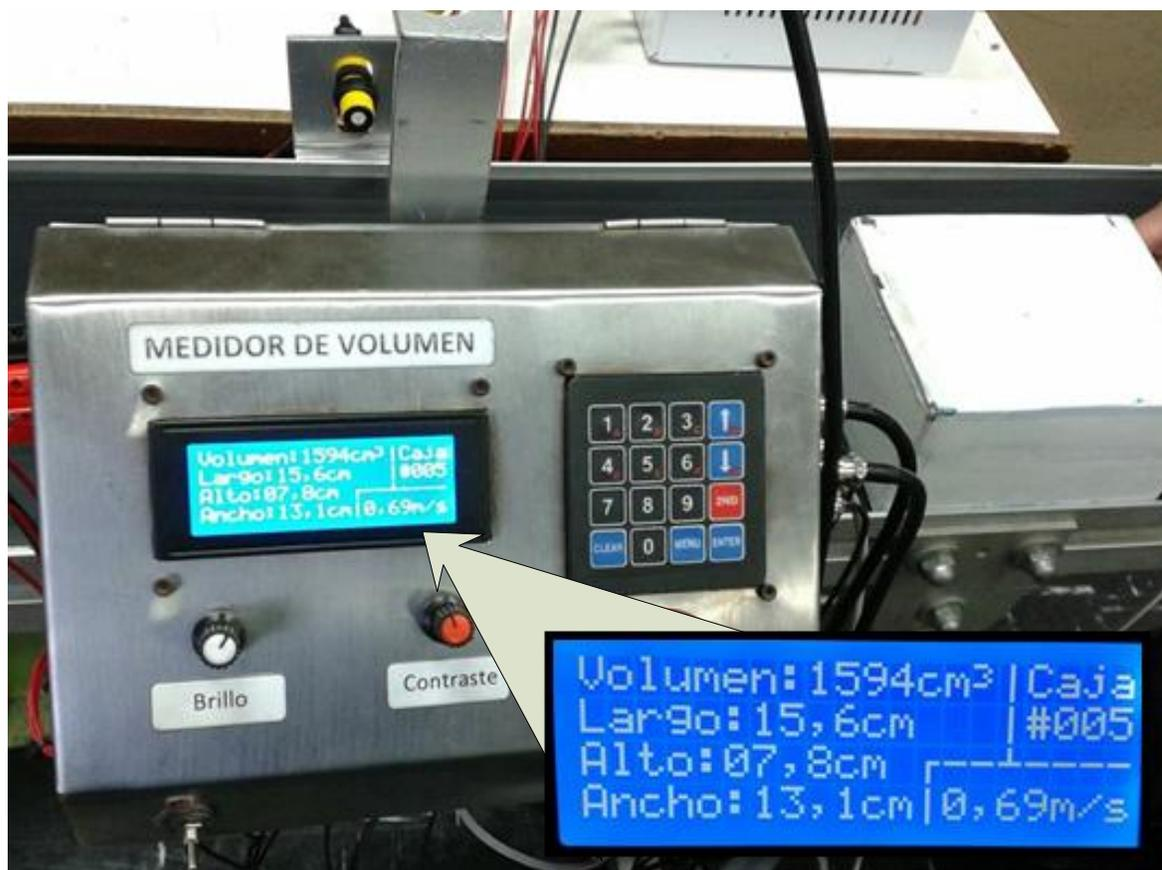
**Figura 4.30.** Pantalla LCD que muestra las medidas de una caja.
