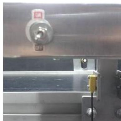
**Fig. 4.22.** Vista posterior de la disposición de los sensores fotoeléctricos.
