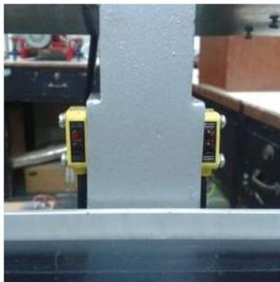
**Fig. 4.21.** Vista frontal de la disposición de los sensores fotoeléctricos.
