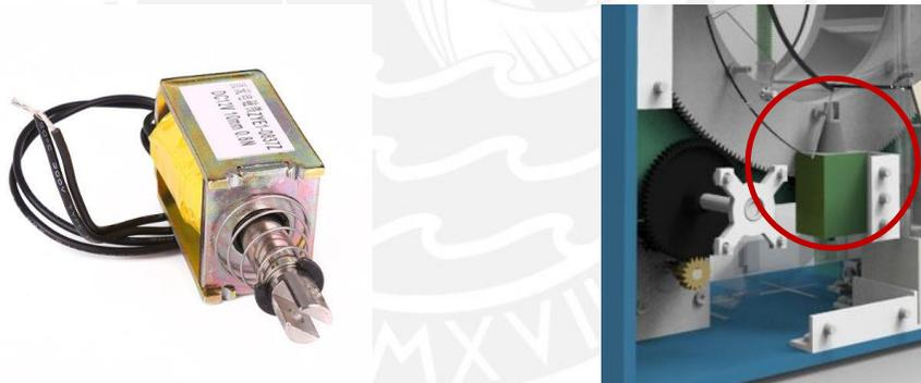
Fig. 3.6 a) Solenoide [18] b) Ubicación (Vista Posterior). Fuente: Elaboración Propia
