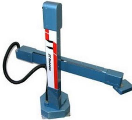
Figura 1.2: Robot manipulador cilíndrico [13]
