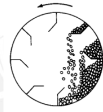
Figura 2.3 Acción en un secadero rotatorio
