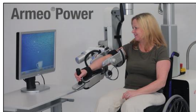
Figura 2.3 - Exoesqueleto para rehabilitación de miembro superior Armeo Power
