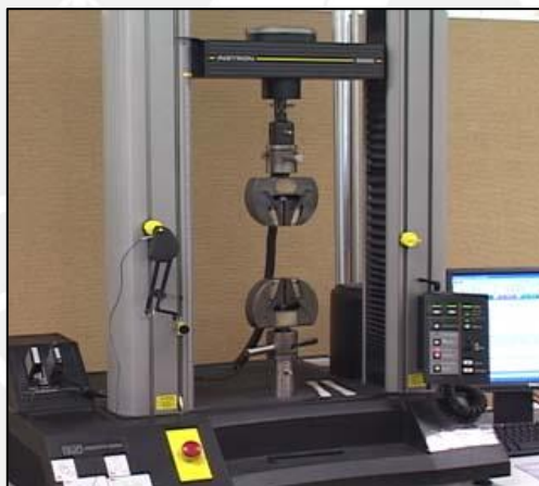
Figura 1.10 Máquina para ensayos de tracción de plásticos [12]
