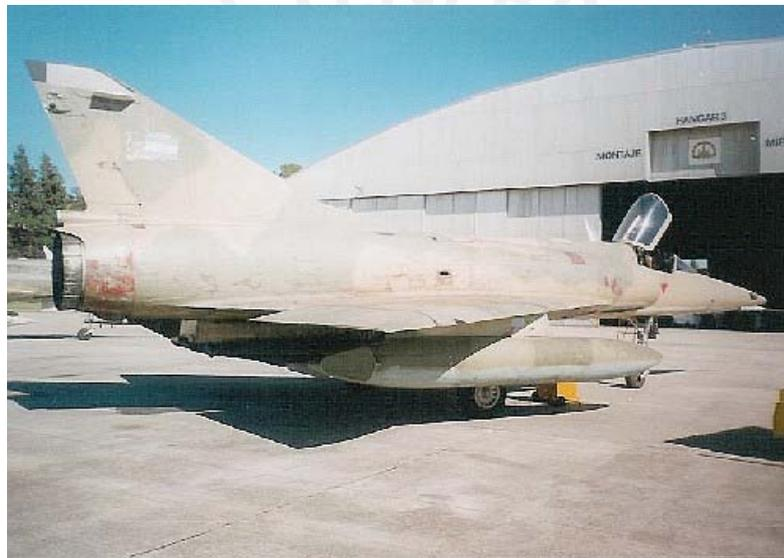
**FIGURA 3.3** El C-628 fotografiado antes de su partida hacia la VI Br Aé luciendo el nuevo esquema "low-viz" del modelo. De ahora en más, su única diferencia externa respecto de los Finger serán las antenas RWR de la trompa. Nótese que no está instalado aún el contenedor del paracaídas de frenado. (Foto: Mauricio Chiófalo) Fuente: Revista Vuelo Rasante: noticias e historia de la aviación militar Marzo, 2003
