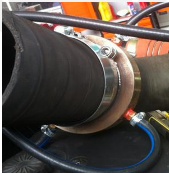
Figura 29 – Anillo mezclador del biogás
