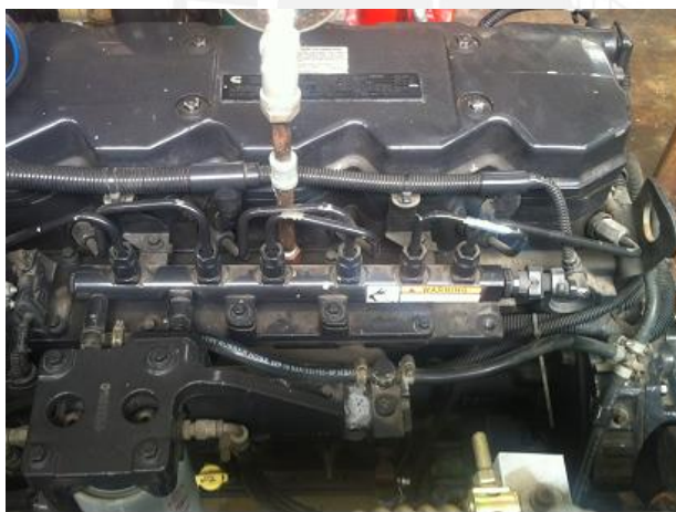
Figura 17- Sistema del riel común del motor Diesel [28]
