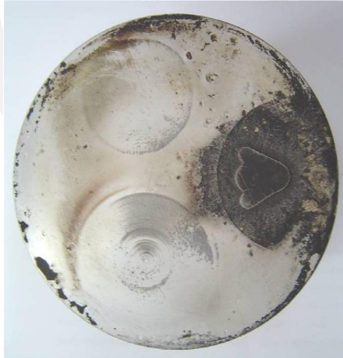
Figura 5-Destrucción del pistón por las altas cargas térmicas en el modo BC al usar biogás [12]
