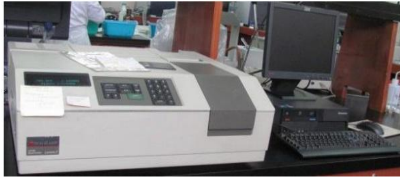
Figura 3.11 Espectrofotómetro de UV/VIS/IR usado para medir las muestra de a-SiN
