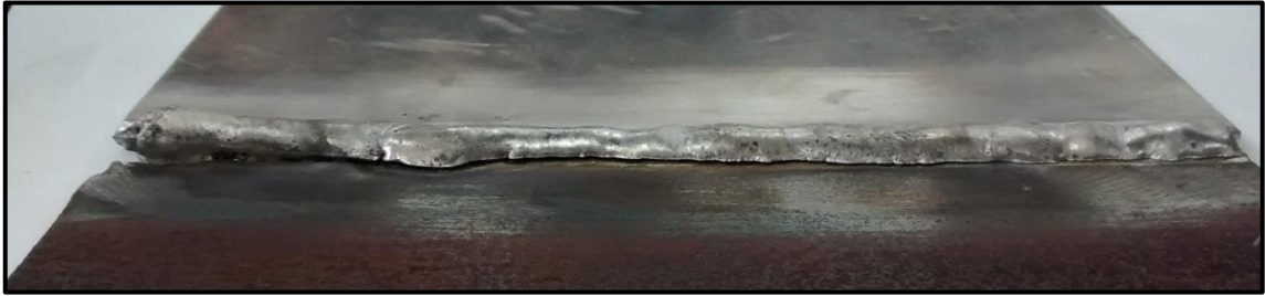
Figura 3.7 Cordón de soldadura bajo el proceso GTAW
