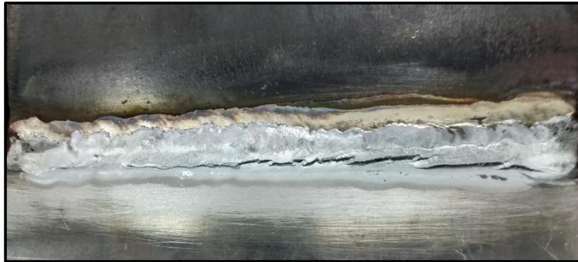
Figura 3.13 Cupón realizado con proceso GTAW Al-5%Si y buttering SMAW
