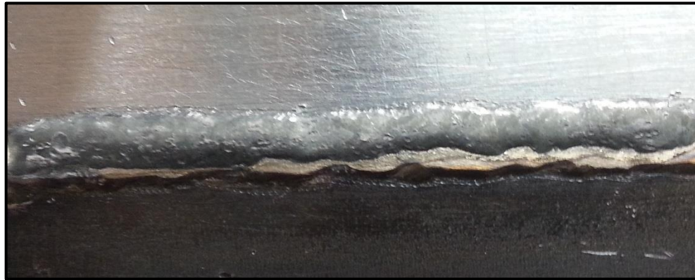
Figura 3.2 Raíz del cordón de soldadura bajo proceso SMAW
