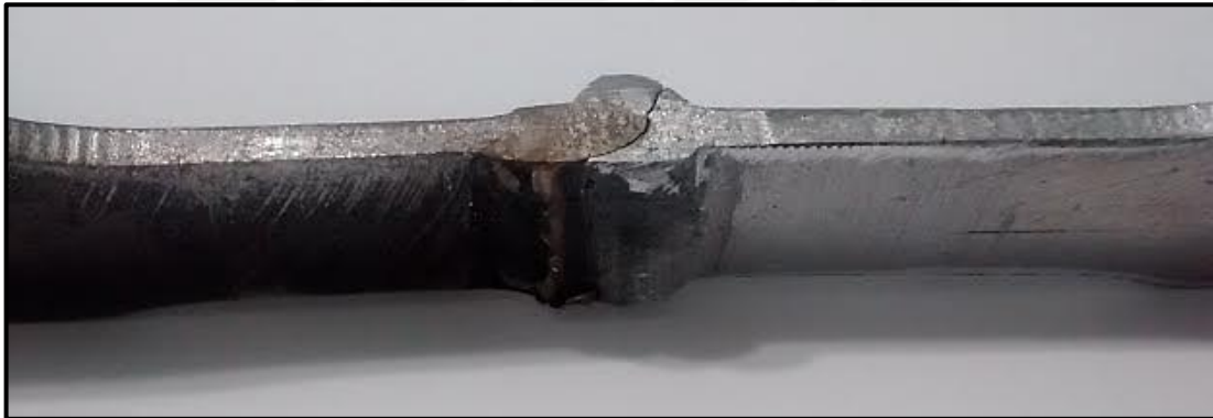
Figura 3.19 Vista transversal al cordón realizado con proceso GMAW
