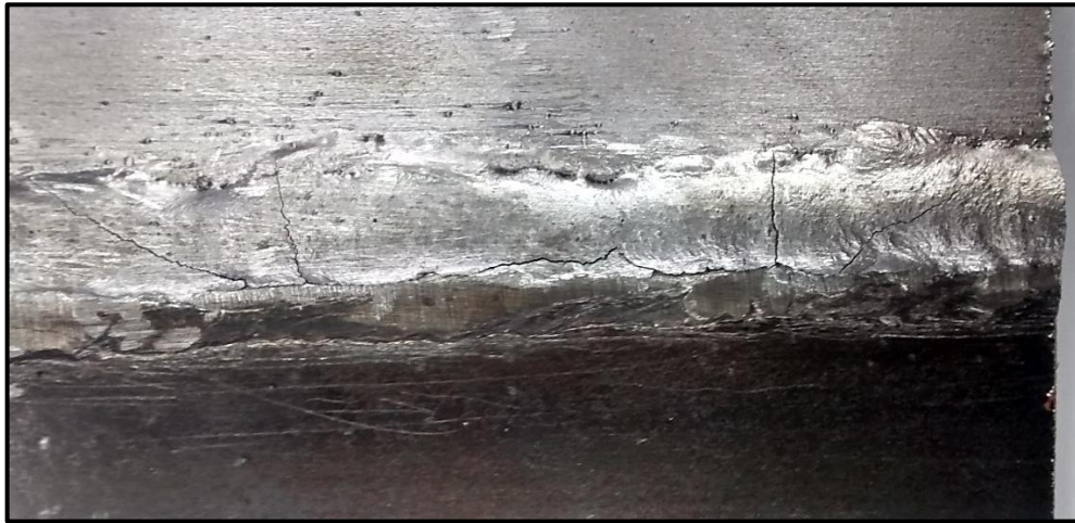
Figura 3.11 Cupón realizado con proceso GMAW y aporte Al-5%Mg
