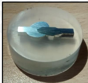
Figura 2.6 Probeta “briquetada” para el ensayo de dureza Vickers
