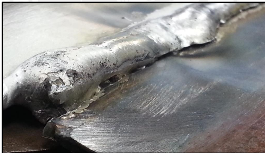
Figura 3.14 Detalle de la falta de dilución
