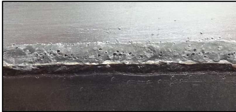
Figura 3.8 Porosidades en la cara del cordón de soldadura bajo proceso SMAW
