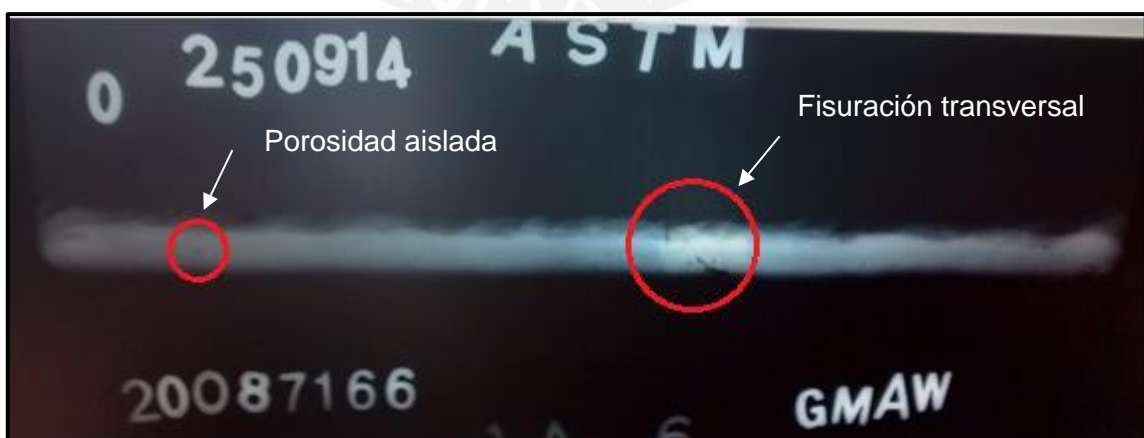
Figura 3.16 Radiografía a cupón elaborado con proceso GMAW utilizando aporte Al-5Si
