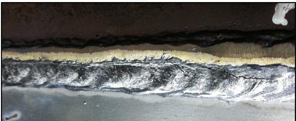
Figura 3.10 Cupón realizado con proceso GMAW y aporte Al-12%Si.
