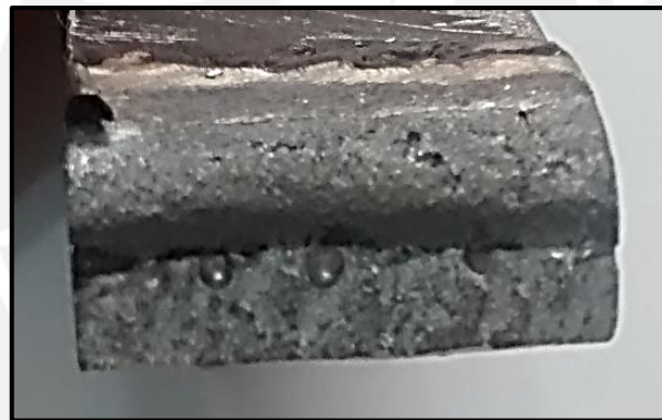
Figura 3.21 Zona de ruptura en el acero
