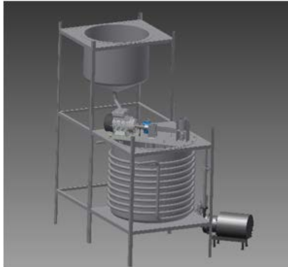
Fig. 2-1: Máquina automática para elaborar manjar blanco Fuente: propia
