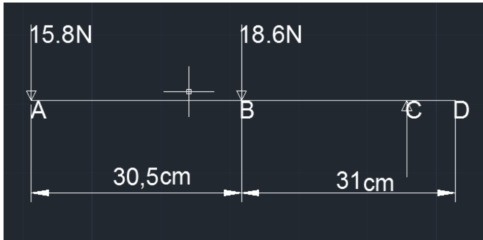
Figura A5.2. Modelo usado para el cálculo del actuador para el brazo
