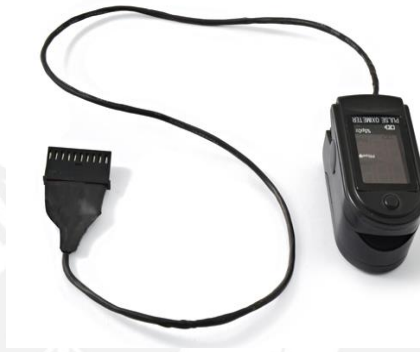
Figura 3.2.3. Sensor de pulso y oxígeno en la sangre para arduino Fuente: arasoloelectronico.blogspot.com
