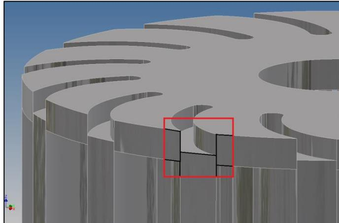
Figura 3. 3-Tipo de unión entre disco lateral y álabe
