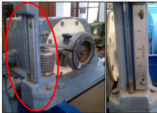
Figura 2. 10–Medidor de fuerza tipo fuelle
