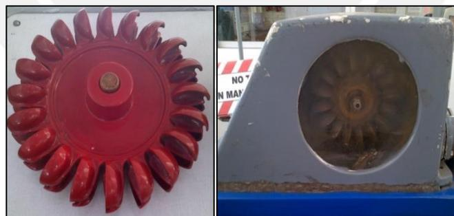
Figura 2. 8-Rotor y Turbina Pelton
