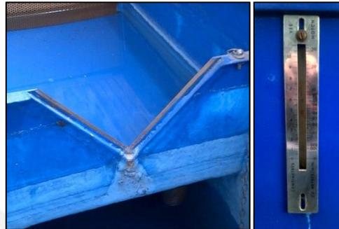
Figura 2. 9–Canal con vertedero triangular y tubo piezométrico
