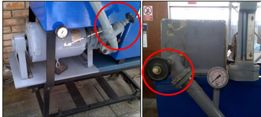
Figura 2. 7-Válvulas de compuerta instaladas
