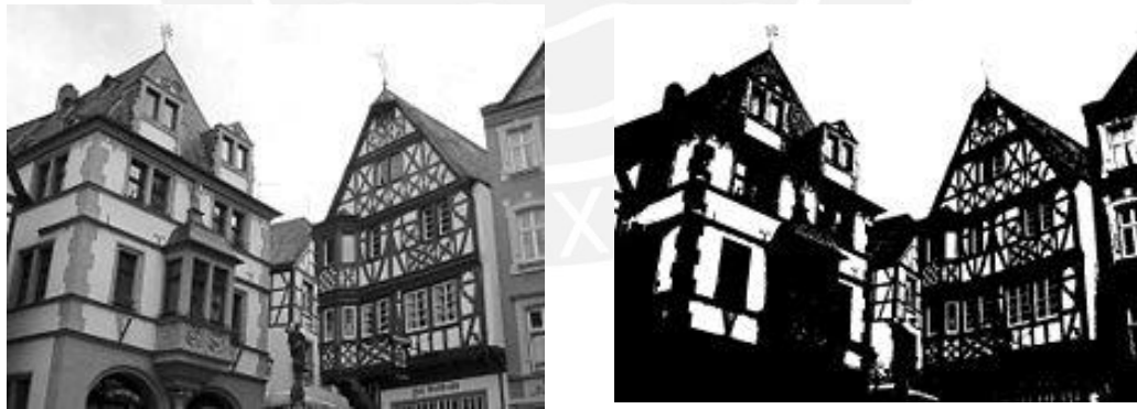
Figura 3.4 Ejemplo de funcionamiento de método de Otsu sobre imagen en escala de grises [Wikipedia, 2014].
