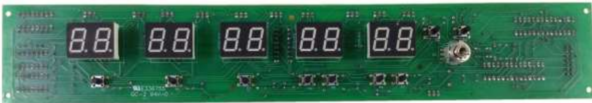
Figura 4.4. Vista Final de la tarjeta de Panel de Control – Lado B
