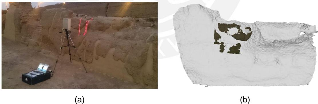
Figura 4.4 En (a) adquisición de datos del primer caso del Camino Inca y en (b) la alineación de reconstrucción del *NextEngine Laser Scanner HD* y Kinect. El modelo a color es resultado del escáner y el blanco del Kinect.
