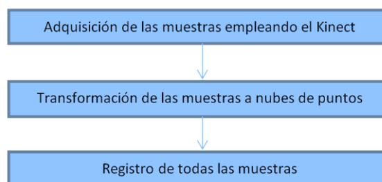
Figura 3.1 Esquema metodológico del algoritmo.
