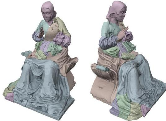
Figura 1.4 Varias muestras unidas procedentes del escáner de triangulación. El color representa un momento diferente de adquisición. Adaptado de [4].
