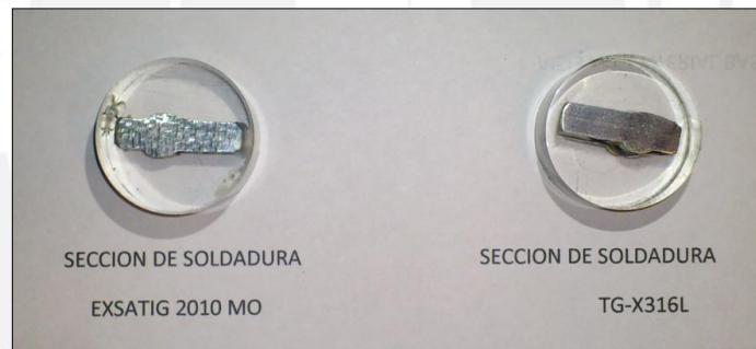
Figura 15: Probetas para ensayos metalográficos.
