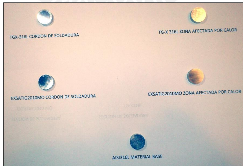
Figura 16: Muestras circulares para ensayos electroquímicos.
