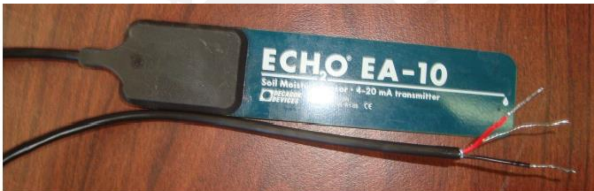
Figura 2.8. Sensor de contenido de agua en el suelo EA- 10 de la empresa DECAGON DEVICES [15]
