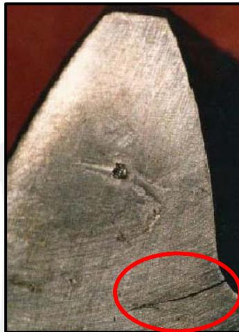
Figura 3.6. Agrietamiento de un diente de engranaje recto, partiendo desde la base del mismo. (Pinochet 2007).
