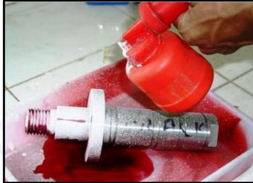
Figura 1.16. Aplicación de líquidos penetrantes para resaltar fisuras (Merino Ponce 2007).
