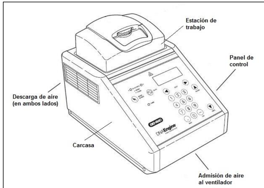
Figura 1.7. Componentes del termociclador de la marca MJ Research, modelo PTC-200 (MJ Research 2004)
