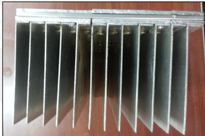
Figura 2.6. Disipador utilizado en el prototipo
