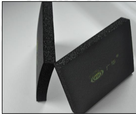
Figura 2.17. Termoaislante de Poliuretano seleccionado para el contorno de la bandeja
