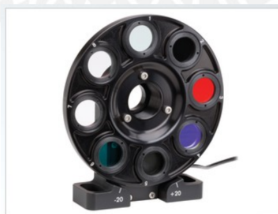
Figura 3.2. Filtro rotativo de 8 filtros. [9]
