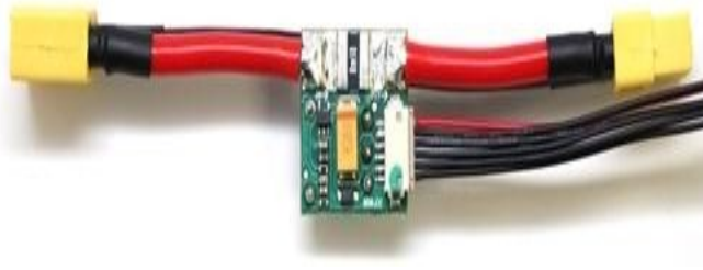
Figura 4.13. APM Power Module.[36]
