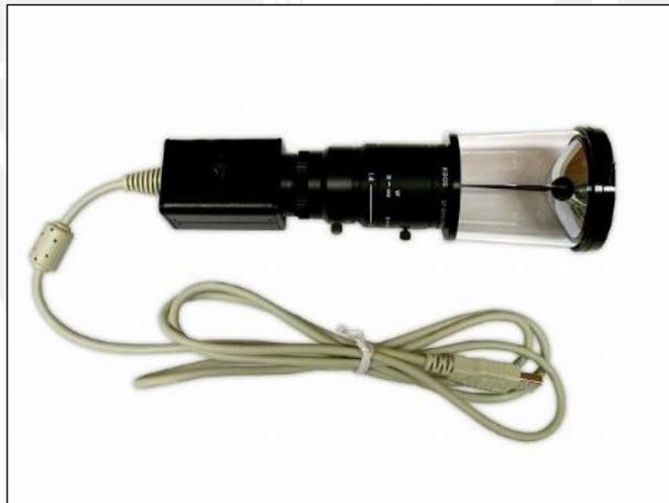
Figura 6. Cámara Omnidireccional
