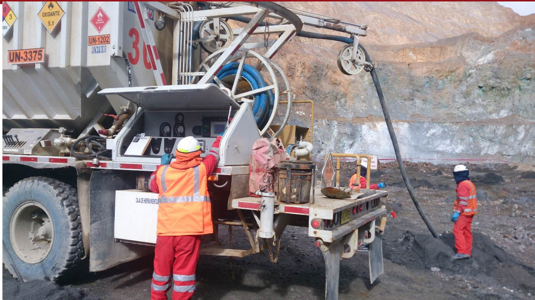
Figura 3-9. Camión-fábrica descargando HA-73 gasificado
