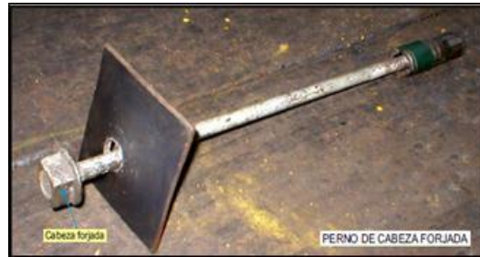
Figura n°11: Perno de anclaje mecánico con cabeza forjada
