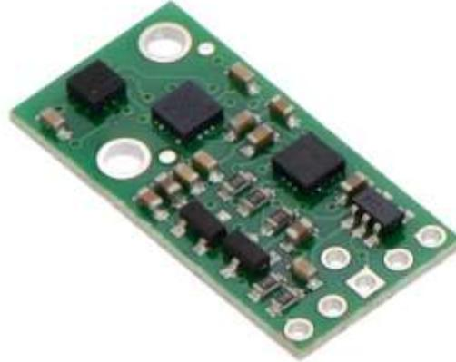
Figura 3.10: Integrado con acelerómetro, girómetro y altímetro. Fuente: POLOLU
